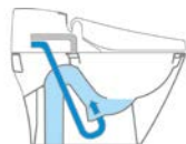
2. Смывание сильной струей воды
