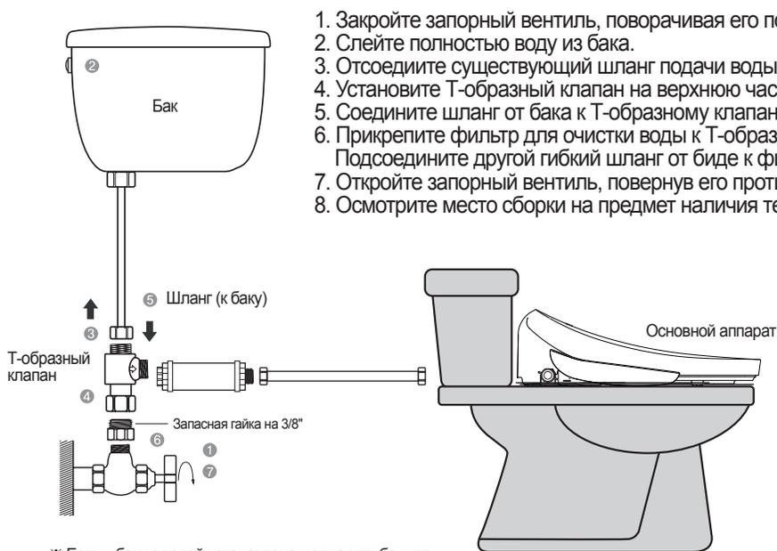
1. Закройте запорный вентиль, поворачивая его по часовой стрелке.
